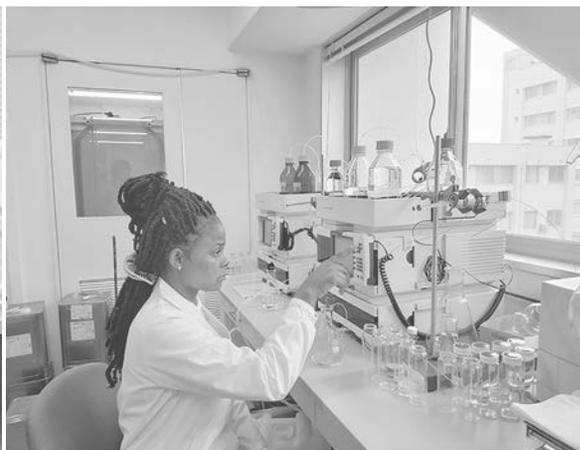
精製機器を用いた化合物の精製
