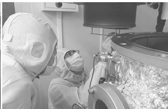
シリコン太陽電池使用の製膜実験
