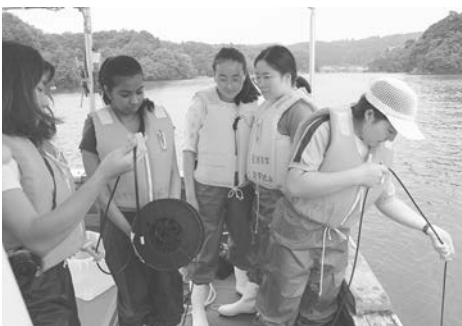
船上でデータを取るための多項目水質計を慎重に下げていきます
