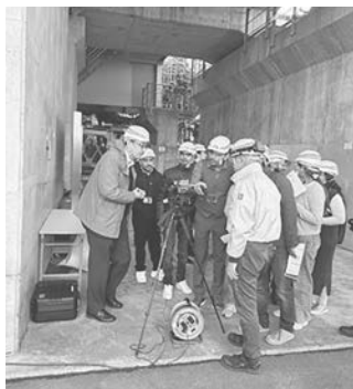
赤外線サーモグラフィーを用いた空洞検査に取り組む
